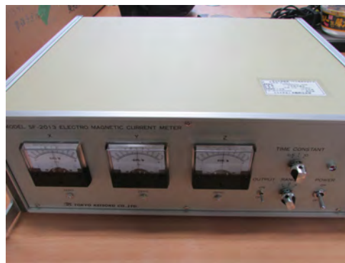
(b) 電磁流速計のアンプ部 (Marine Hydro. Lab. 所有)
