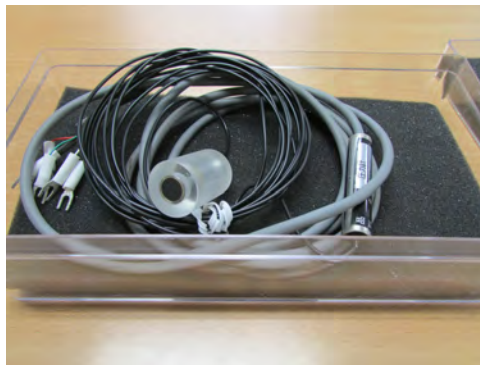
図 1: ひずみ式圧力計 (Marine Hydro. Lab. 所有)
